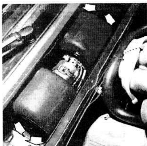
Снятие электро- вентилятора отопителя
