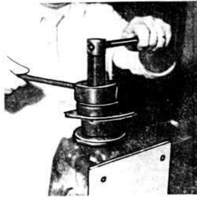
Напрессовка фланца на ведущую шестерню приспособлением 23 1 300
