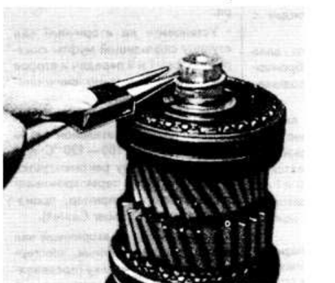
Снятие стопорного кольца с конца вторичного вала
